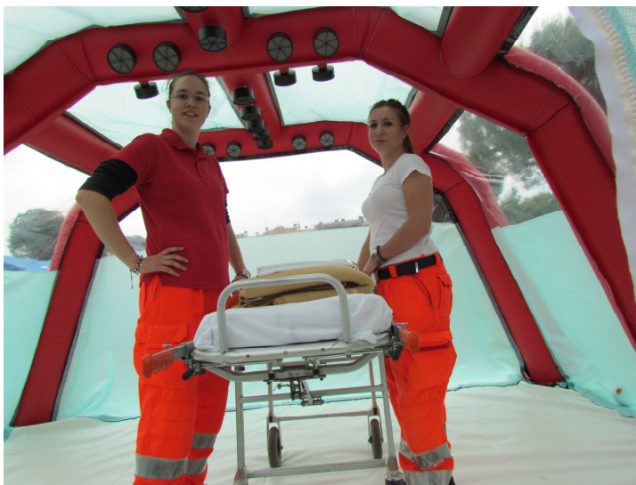
La struttura a contaminazione controllata è dotata di elementi filtranti cilindrici di grado HEPA disposti a soffitto nella configurazione "spot" verso l'area critica.
